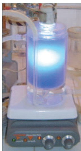
Figura 8: Fotoreator utilizado para realização do experimento de fotocatalise em UV.
