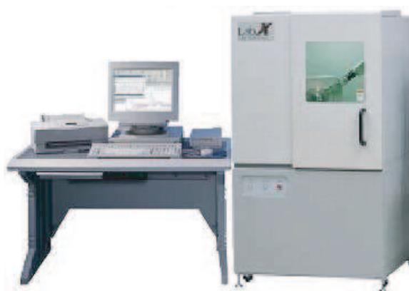
Figura 11: Difratômetro de pó Shimadzu XRD-6000 usado nos experimentos.
