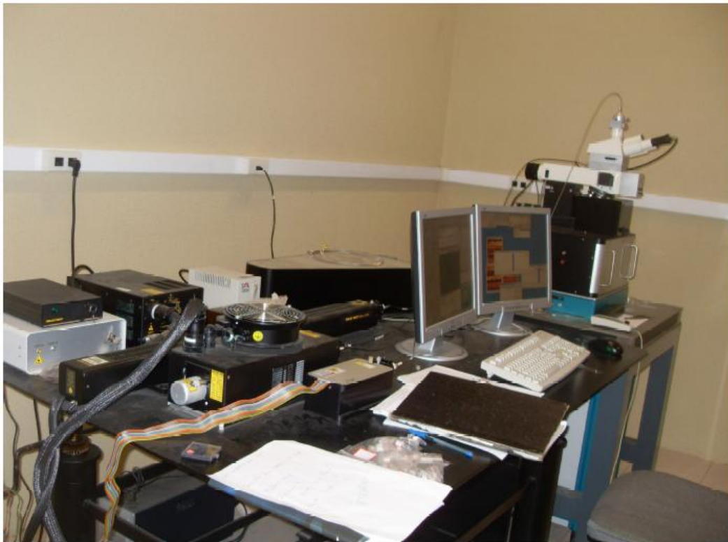
Figura 32 - Aparato utilizado para as medidas de Microscopia Óptica e Raman Confocal [52].
