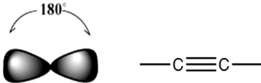
Figura 6 - Representação da configuração dos orbitais do átomo de carbono na hibridização sp e do radical cuja repetição forma a cadeia carbônica linear das carbinas.
