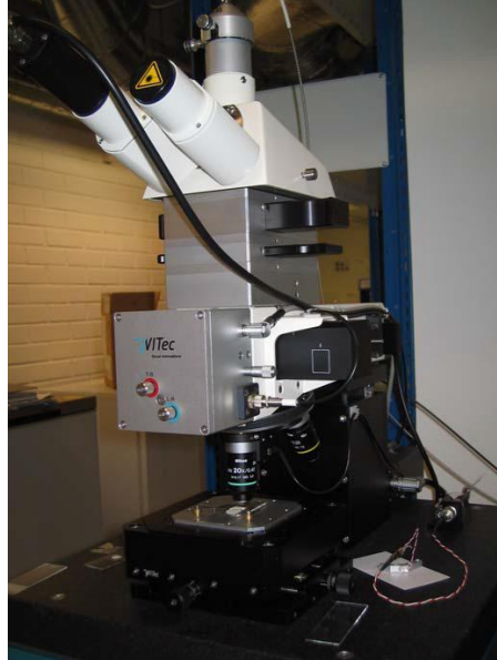
Figura 28 – Microscópio Confocal alpha300R da Witec, utilizado para visualizar os filmes gráfiticos sintetizados [54].
