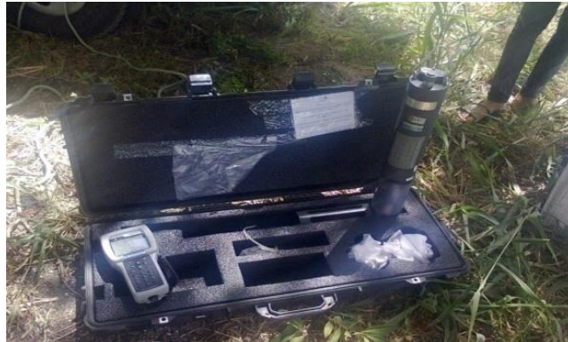
Figura3 - Sonda multiparamétrica usada nas coletas
