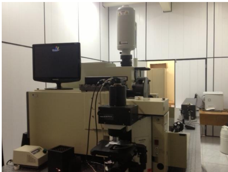
Figura 5. Espectrômetro, CCD e microscópio utilizado nos experimentos de espectroscopia Raman à temperatura ambiente.
