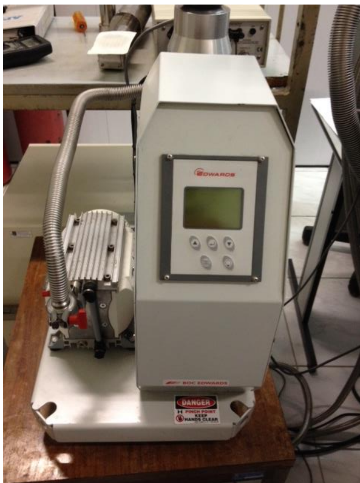
Figura 12. Sistema de alto vácuo modelo E2M8 da Edwards Vacuum Ltda.
