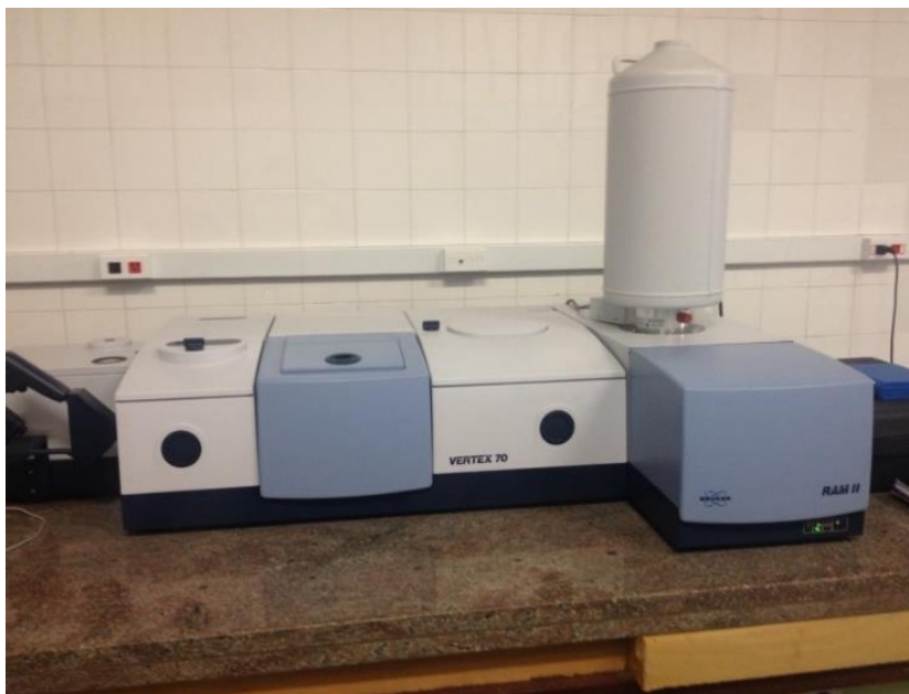
Figura 6. Espectrômetro FT-IR da Bruker utilizado no experimento de infravermelho na amostra de L-histidinato.
