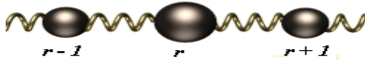
Figura 1.3 Rede linear diatômica com átomos de massa M e m . A constante de força entre cada átomo é considerada a mesma.
