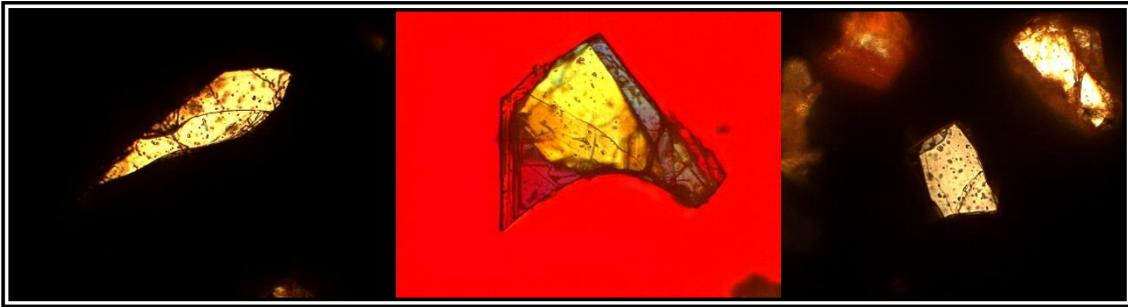
**Figura 4.14.** Cristais de  $\text{Pb}_8\text{O}_5(\text{VO}_4)_2$  com diâmetros da ordem de centenas de micrômetros que apresentam ausência de padrões de domínios ferroelásticos em suas superfícies.
