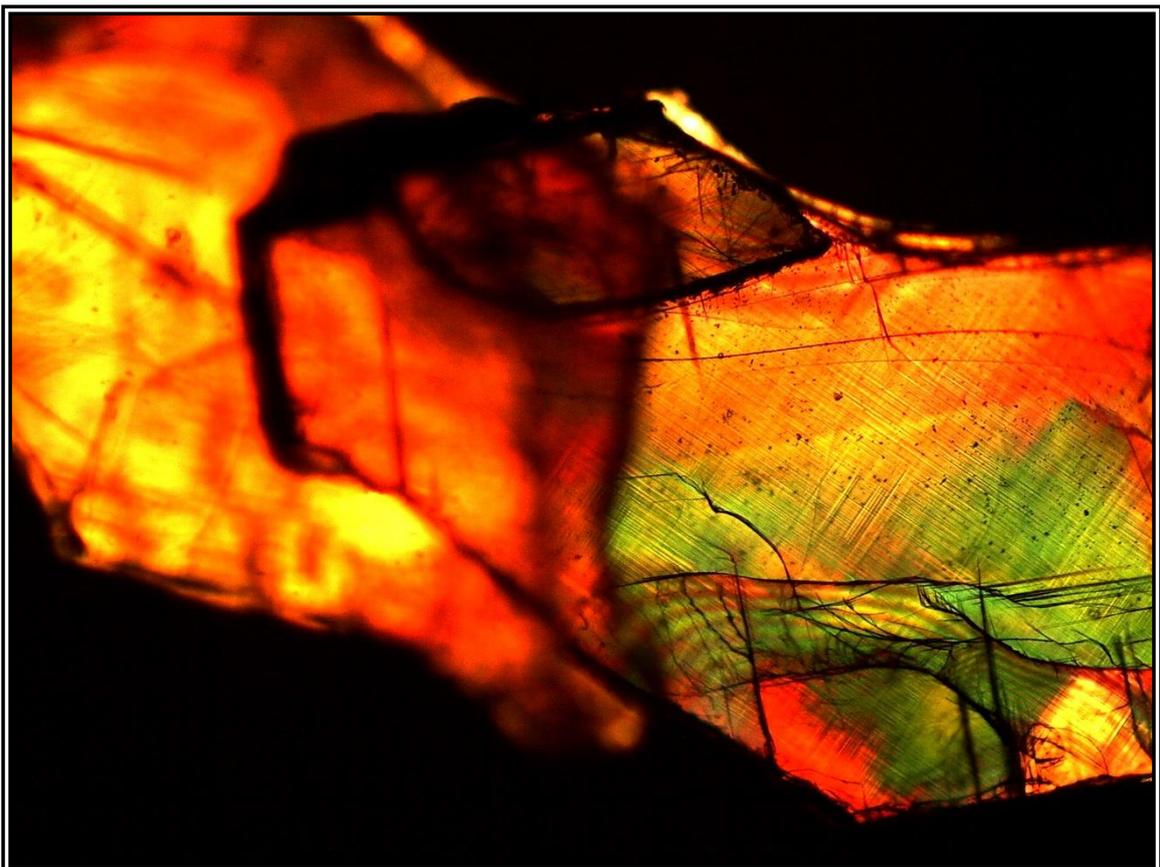
**Figura 4.15.** Cristais bulk de  $\text{Pb}_8\text{O}_5(\text{VO}_4)_2$  sob condições ambientes de temperatura e pressão onde observa-se padrões de domínios ferroelásticos em forma de cunha ou V em suas superfícies.
