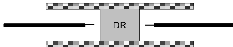
Figura3.5- Configuração de um DR entre as placas condutoras paralelas e as sondas.
