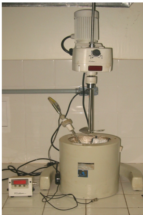
Figura 9. Agitador de baixo cisalhamento utilizado na preparação das misturas.
