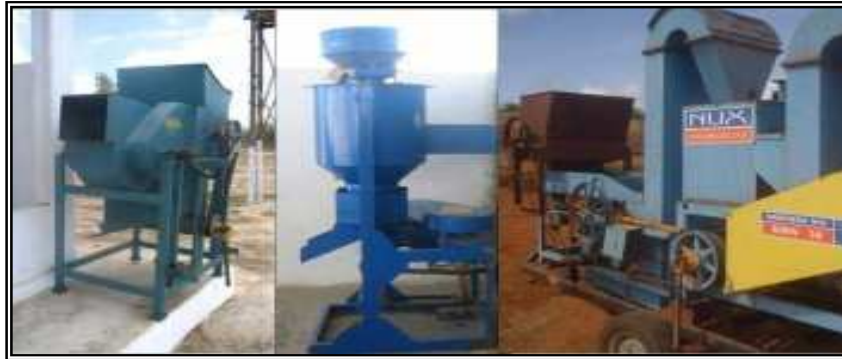
Figura 7 - Modelos de descascadoras de mamona estacionários e móveis. Fonte: EMPRAPA (2004).
