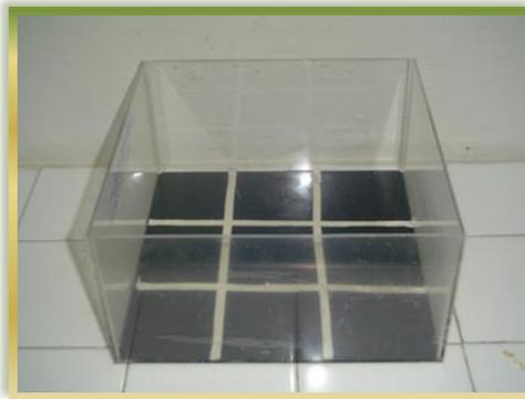
**Figura 6:** Equipamento para teste do campo aberto
