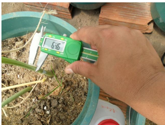
Figura 9: Medição de diâmetro da haste principal.
