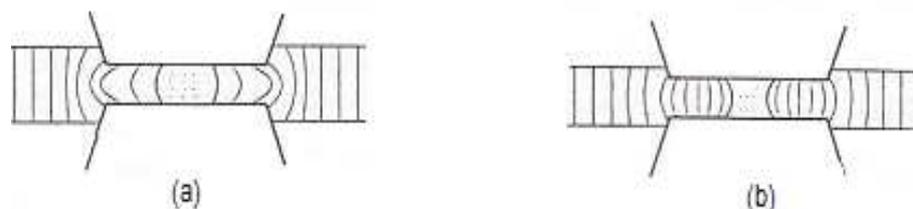
Figura 17: (a)Gaxeta grossa (b) Gaxeta fina. As linhas finas mostram o movimento do aço durante a pressurização. Em (a) o aço se move para o exterior e o orifício da gaxeta fica forma de barril. Em (b), a gaxeta se encontra pressurizada pelo movimento para dentro [28].
