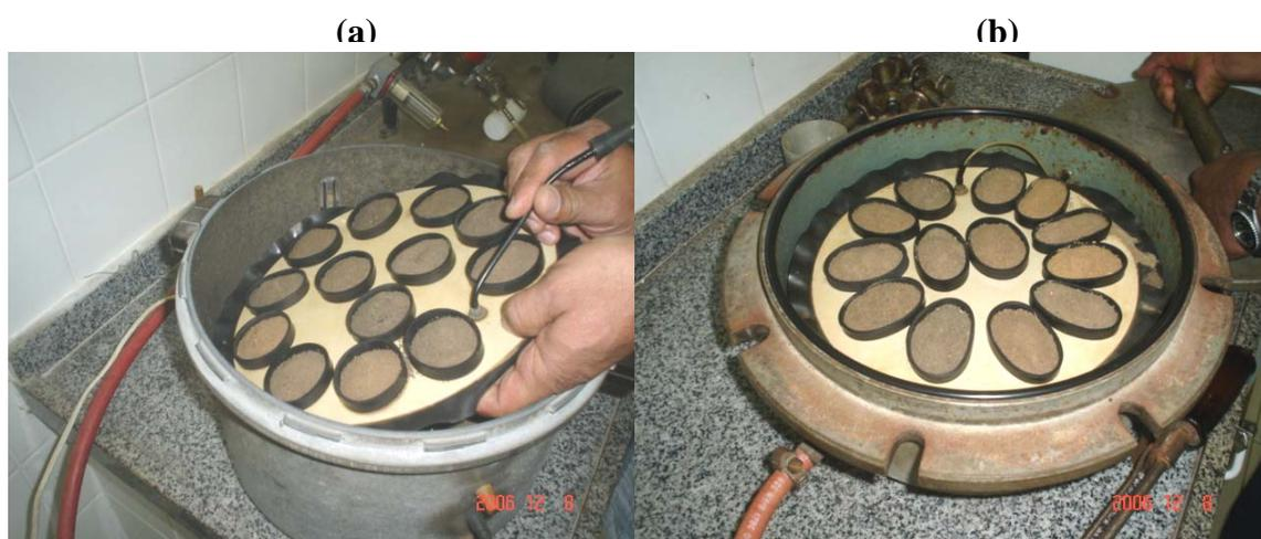
**Figura 4. Aplicação das tensões de 0,033 MPa (a) e 1,5 MPa (b) no aparelho extrator de Richards, respectivamente.**
