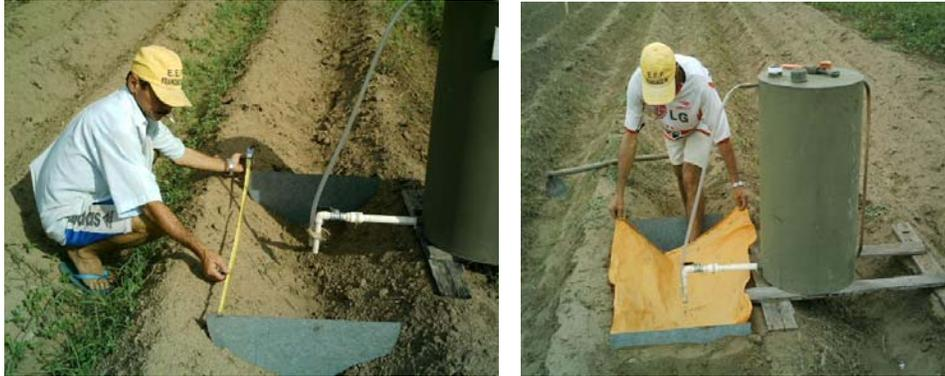
**Figura 3.** Teste de campo com sulco infiltrômetro.
