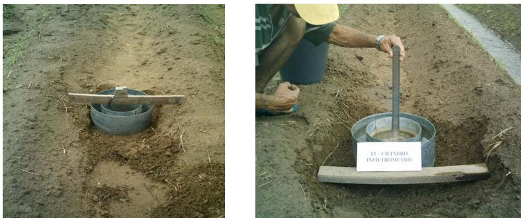
**Figura 2.** Teste de campo com cilindro infiltrômetro.
