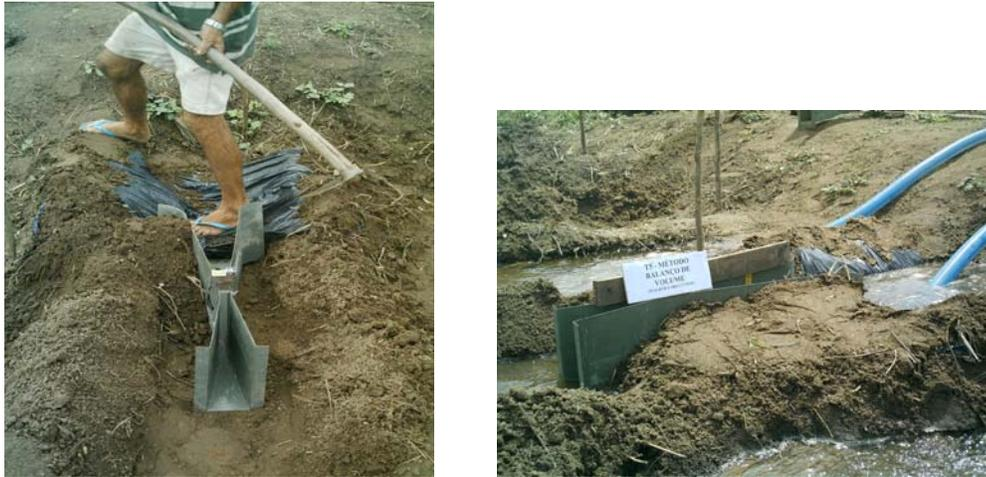
**Figura 4.** Teste de campo pelo método de entrada e saída
