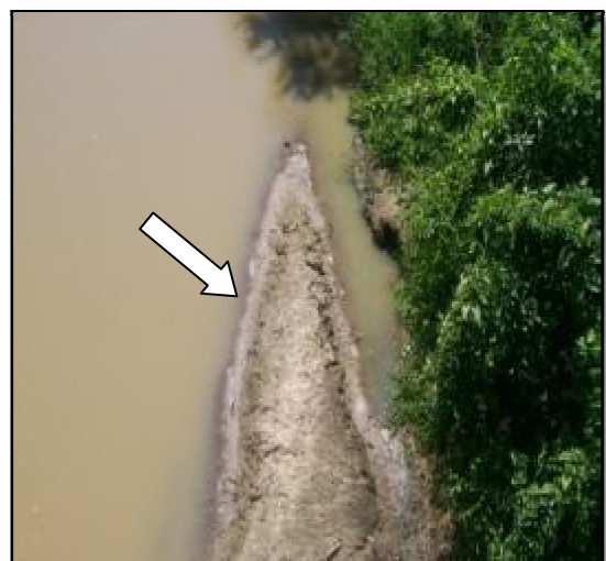
Figura 38: banco de sedimentos na margem direita do rio. Notar que nesse trecho a mata ciliar encontra-se conservada, estando o assoreamento associado a barragem do açude Acarape do Meio
