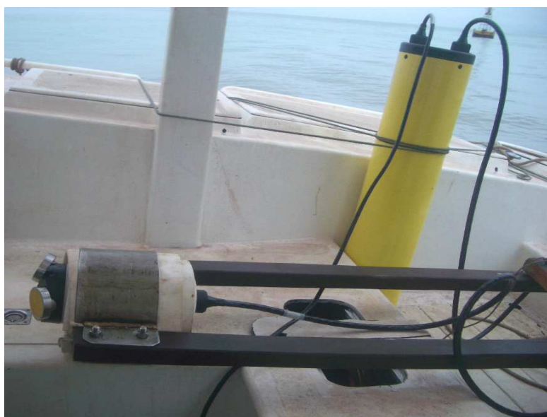
Figura 10 - Transdutor da ADCP utilizado para medição da direção e velocidade das correntes marinhas.
