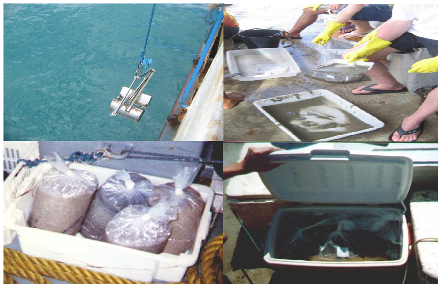
Figura 6 - Aspecto das diversas etapas de coleta e acondicionamento das amostras de sedimento na área de influência do Sistema de Disposição Oceânica dos Esgotos Sanitários de Fortaleza, Ceará.
