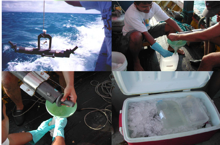
Figura 7 - Aspecto das diversas etapas de coleta e acondicionamento das amostras de água na área de influência do Sistema de Disposição Oceânica dos Esgotos Sanitários de Fortaleza, Ceará.
