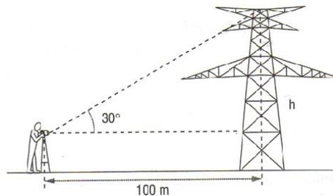
Para tornar possível a aula que consiste em determinar alturas inacessíveis e levando-se em consideração o fator tempo optamos por construir um “modelo de teodolito” básico com a finalidade de obtermos a inclinação (conforme figura). Para isso usamos uma cópia de um transferidor de  $180^\circ$ , um canudo que servirá como mira e um prumo.
