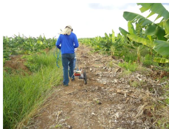
Figura 4 – Aquisição de dados em campo com GPR
