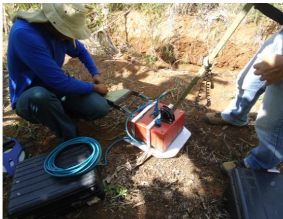
Figura 2 – Estrutura para coleta de dados com GPR
