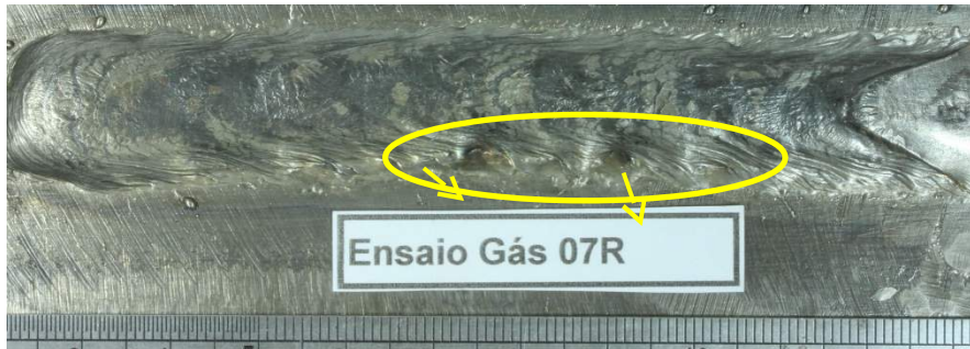
Figura 18 - Exemplos de defeitos nas soldagens com tensão constante e transferência por curto circuito
