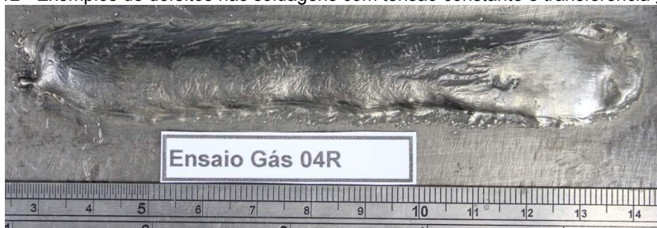
Figura 12 - Exemplos de defeitos nas soldagens com tensão constante e transferência goticular
