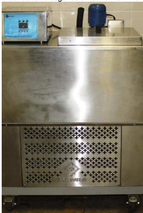
Figura 5 - Banho ultratermostático utilizado para realização de ensaio de imersão em solução de cloreto de ferro segundo a norma ASTM G48.
