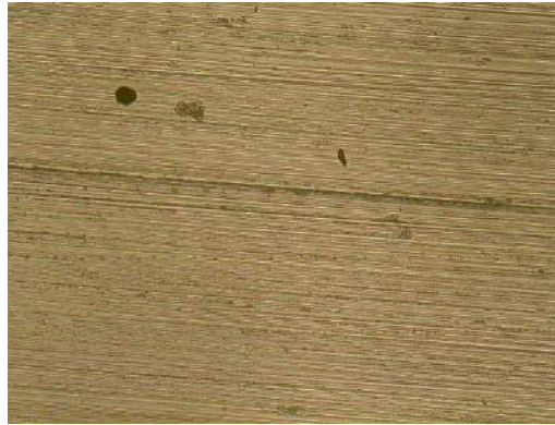
Figura 39 -Fotos dos pites nas amostras de maior diluição a) aumento de 50x. b) aumento de 5x. c) aumento de 20x.
