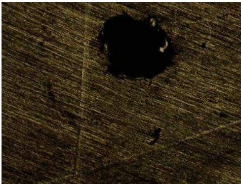
Figura 40 - Fotos do pite na amostra de menor diluição a) aumento de 5x. b) aumento de 50x. c) e d) aumento de 20x.
