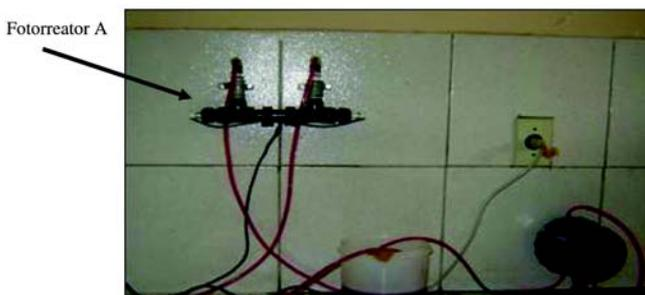
No fotorreator A foram realizados dois ensaios em batelada com recirculação, com volume de recirculação de 800 mL de lixiviado e tempo total de reação de 5 horas. O primeiro ensaio foi feito sem agitação mecânica ( $AM_{Sagit}$ ) e o segundo com agitação mecânica ( $AM_{Cagit}$ ), no intuito de avaliar a influência da agitação na interação do  $H_2O_2$  com a amostra.
