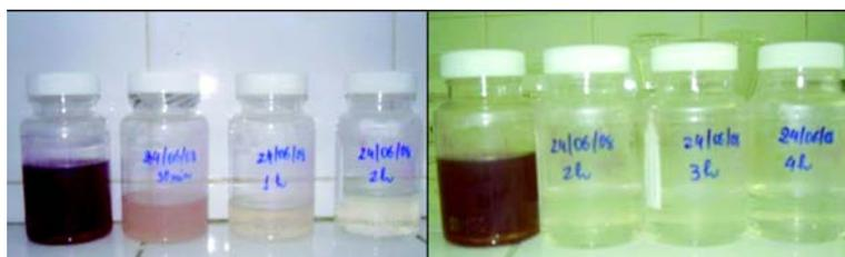
● No fotorreator B os resultados foram bem melhores, visto que a intensidade das lâmpadas foi aumentada aproximadamente em 13 vezes. Assim, o fotorreator B será o sistema adotado para os próximos testes, operado com a vazão de 1500 mL/h.
