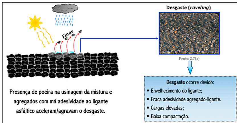
Figura 2.7 – Desgaste do pavimento asfáltico
