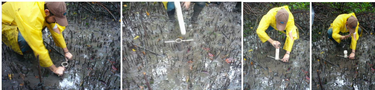
Figura 3.4- Etapas básicas de coleta em solos de manguezais (Fonte: LOPES, C. C., 2009).
