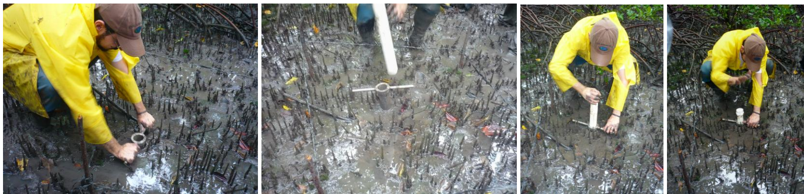
Figura 4.4- Etapas básicas de coleta em solos de manguezais (Fonte: LOPES, C. C., 2009).
