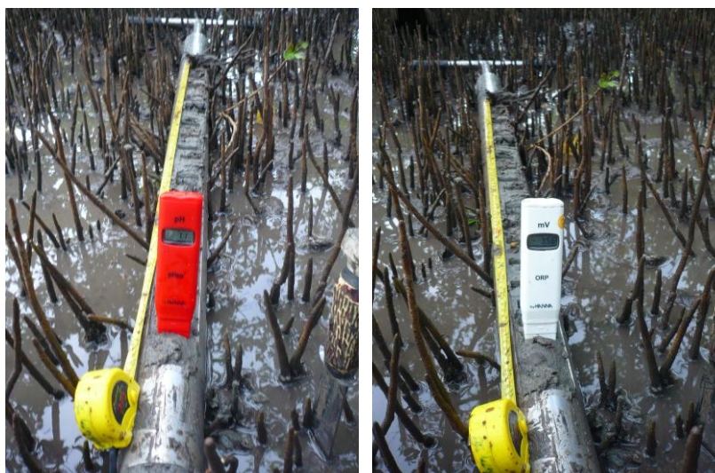
Figura 3.5- Determinação em campo dos valores de pH e Eh do solo (Fonte: MARQUES, A. G. B., 2009).
