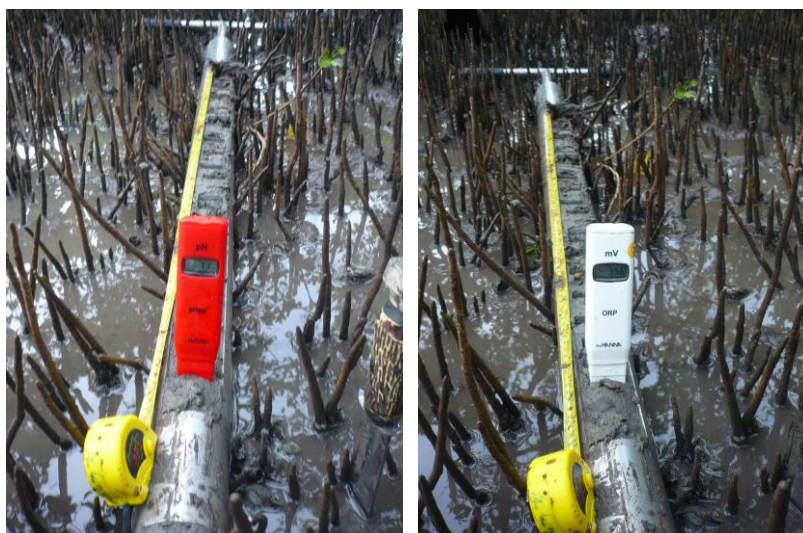
Figura 4.5- Determinação em campo dos valores de pH e Eh do solo (Fonte: MARQUES, A. G. B., 2009).
