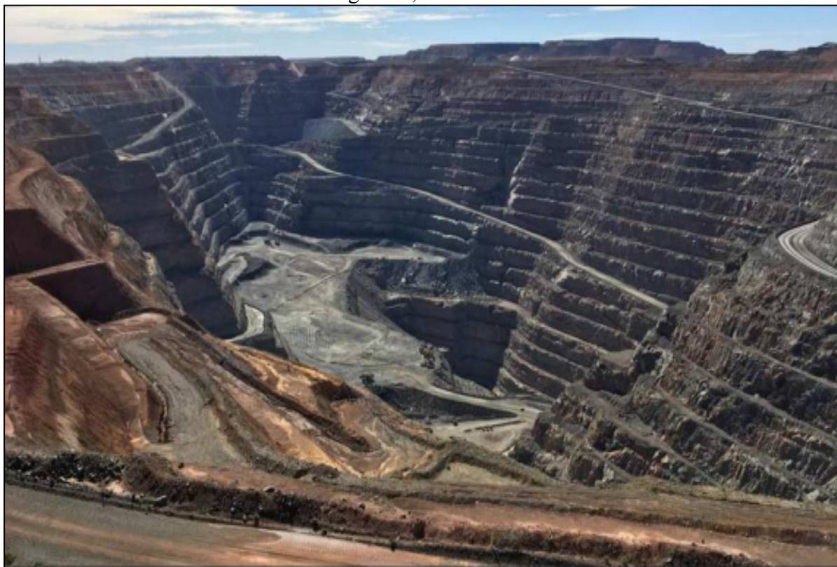
Figura 02: Exemplo do método de lavra em bancadas na mina de Fimiston em Kalgoorlie, Austrália.
