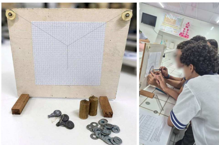
Figura 10 – Experimento de equilíbrio de forças e alunos realizando o experimento.
