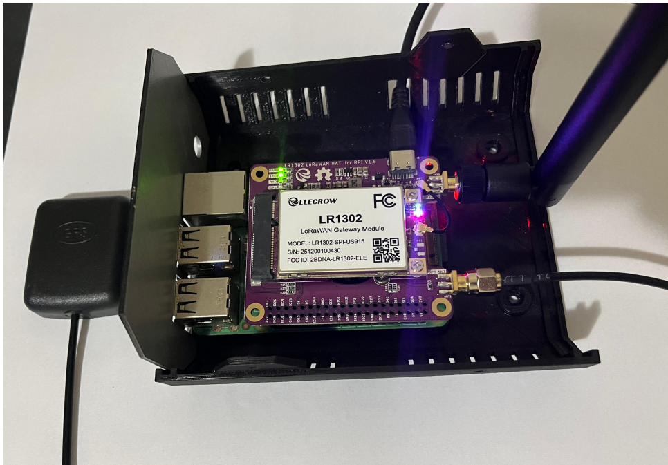
Figura 15 – Gateway LoRaWAN implementado com Raspberry Pi 4 e Elecrow LR1302.
