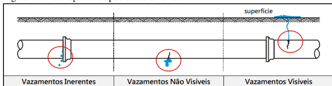
Figura 1 – Ilustração dos tipos de vazamentos.
