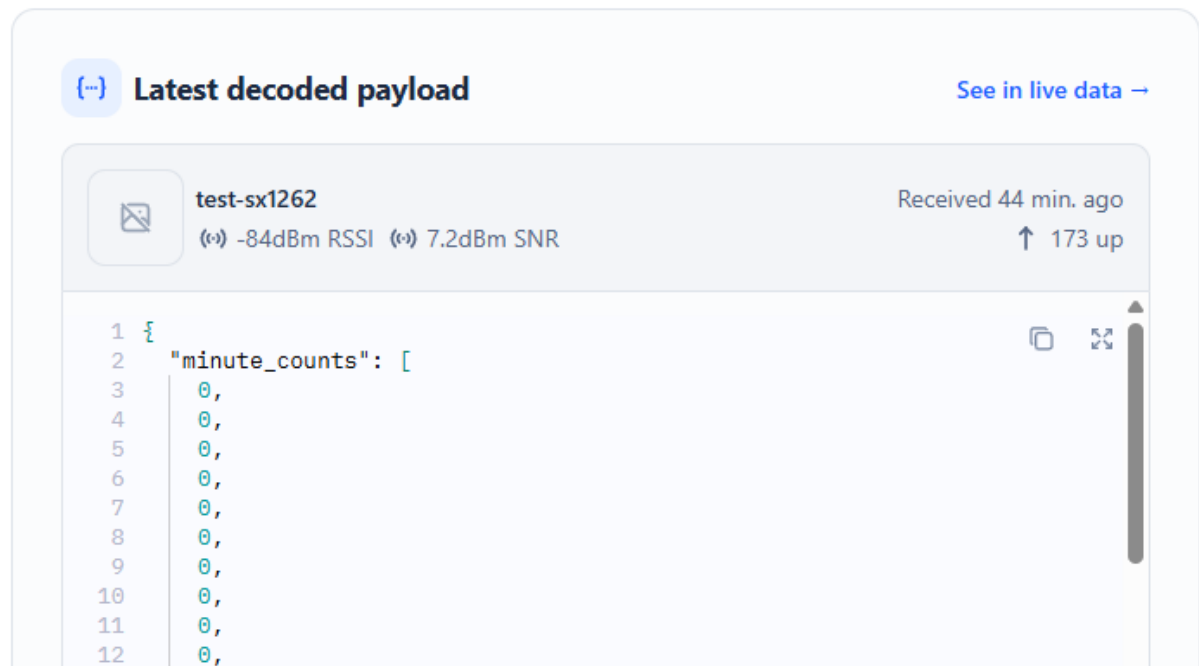
Figura 16 – Exemplo de pacote recebido e decodificado na TTN , posteriormente encaminhado à infraestrutura FIWARE
