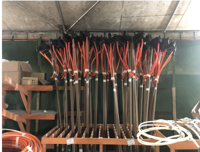
Figura 12 – Exemplo de Kit de Ar-condicionado
