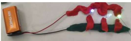
Figura 2 – Circuito elétrico simples construído com massinha de modelar durante a atividade experimental.
