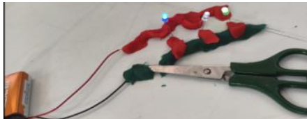
Figura 1 – Circuito elétrico utilizando massinha de modelar e tesoura metálica como elemento condutor durante a atividade experimental.
