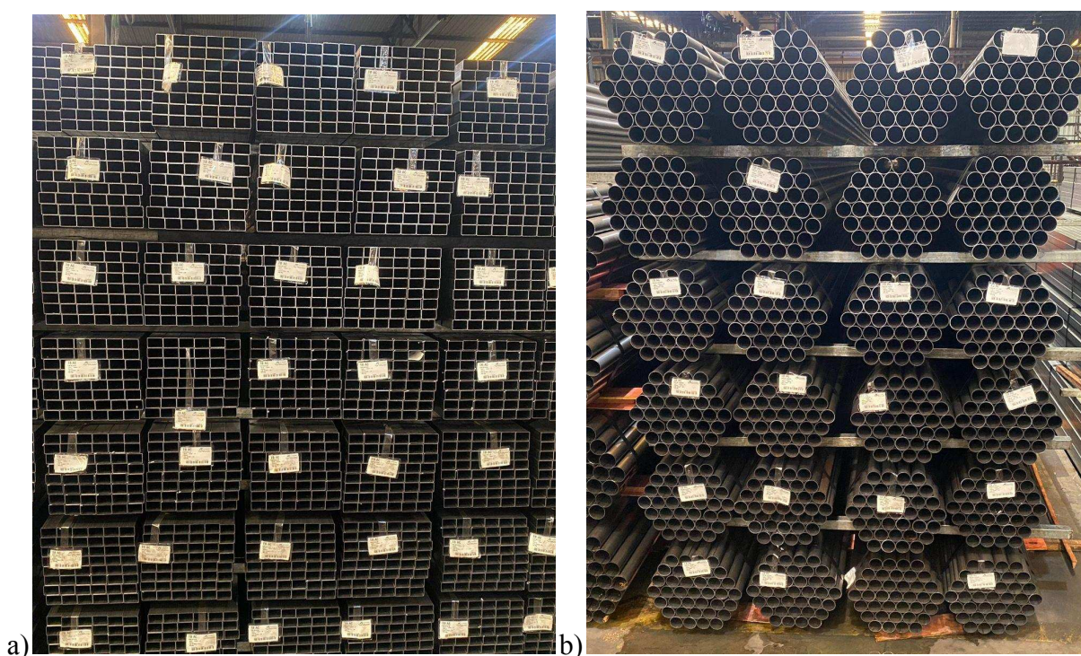
Figura 5 - Fardos de tubos de seção a) quadrada e retangular e b) formação hexagonal, processados no final de linha da MT04.
