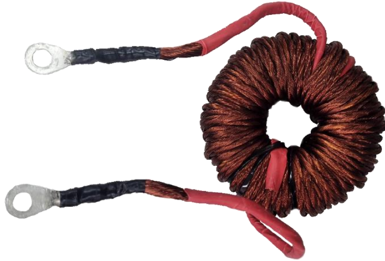
Figura 33 – Indutor L_1 projetado com 69 espiras e 84 condutores AWG26 em paralelo.
