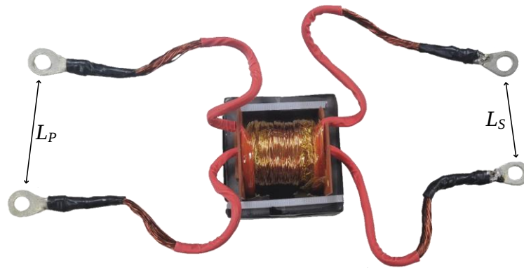
Figura 37 – Transformador projetado com 12 espiras e 25 condutores 22AWG em paralelo, no primário e secundário.
