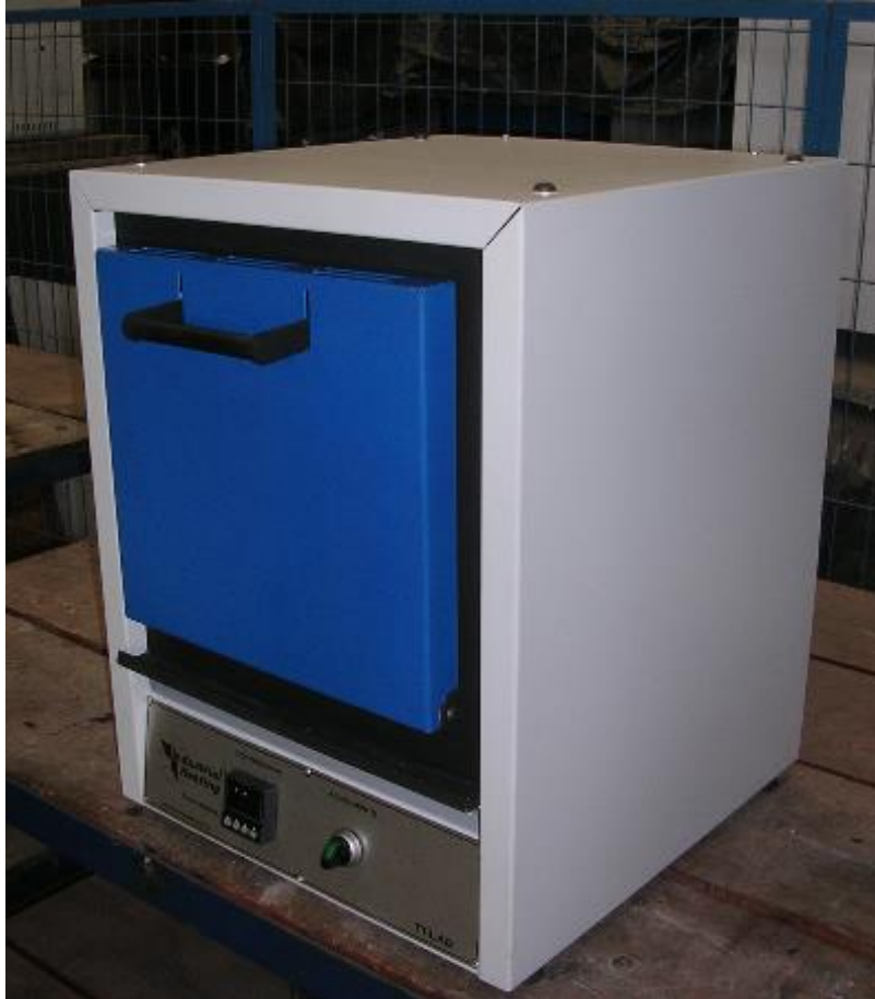
Figura 14 – Forno Mufla 1400°C sem proteção gasosa.
