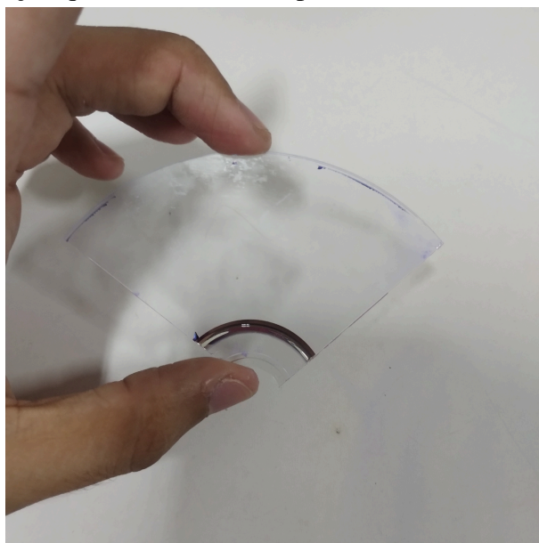
Figura 27: Rede de difração que será usada no experimento.
