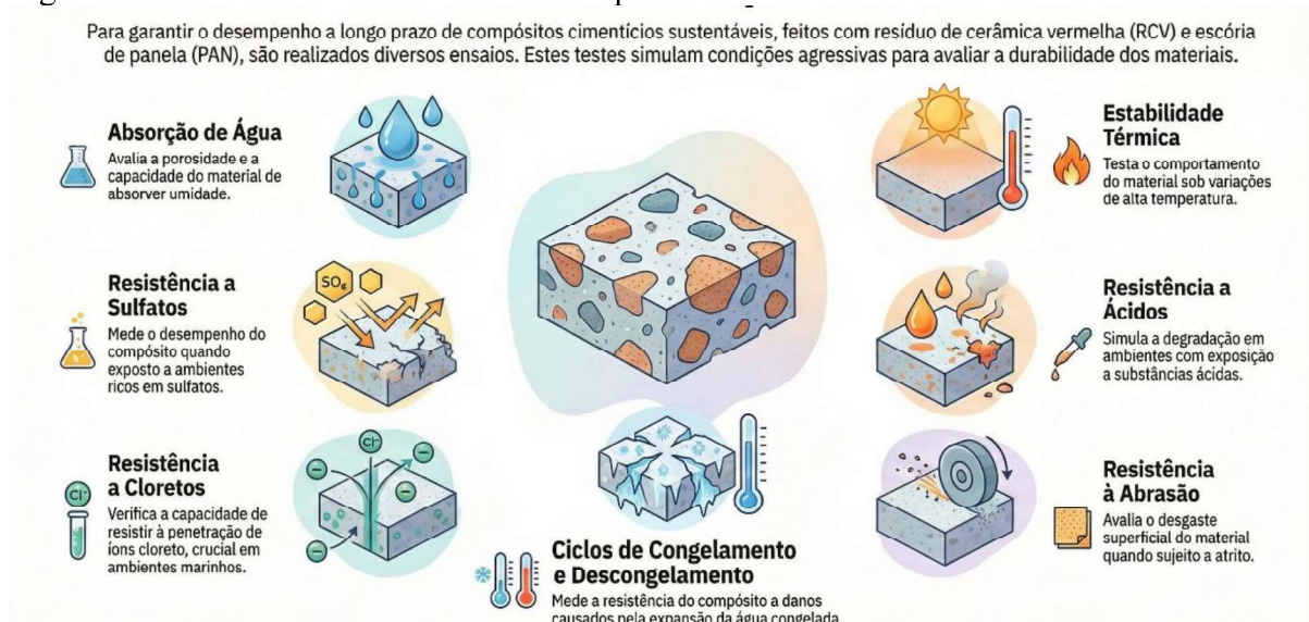
Figura 7 – Ensaio de durabilidade em compósitos álcali-ativados
