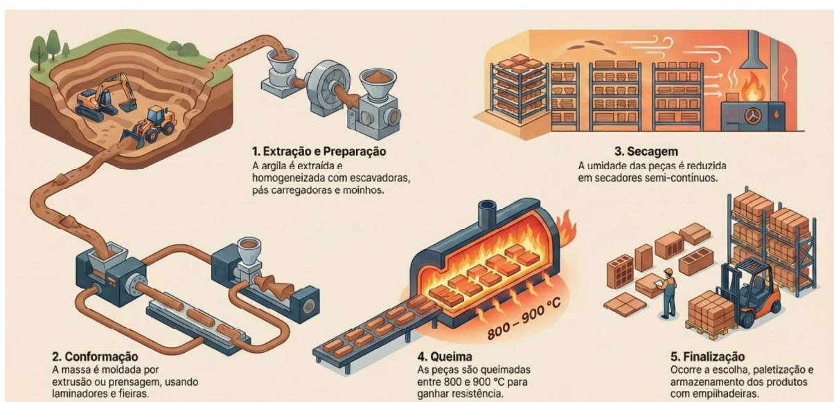
Figura 2 – Processo de fabricação da cerâmica
