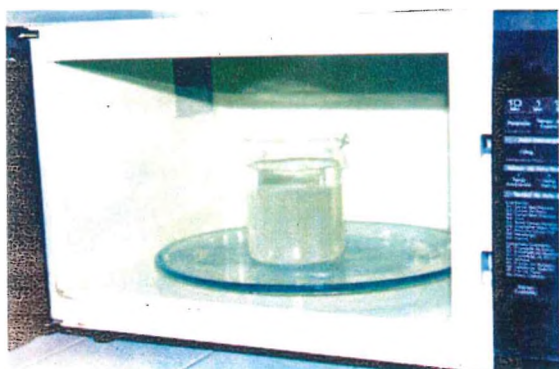
Figura 3: Lâminas em solução de tampão citrato (fase de ebulição).
