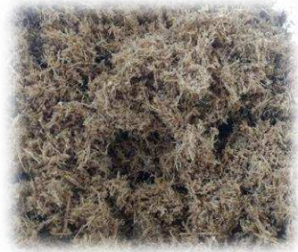
Figura 14 – Bagaço de cana-de-açúcar após o processo de pré-tratamento por explosão a vapor.
