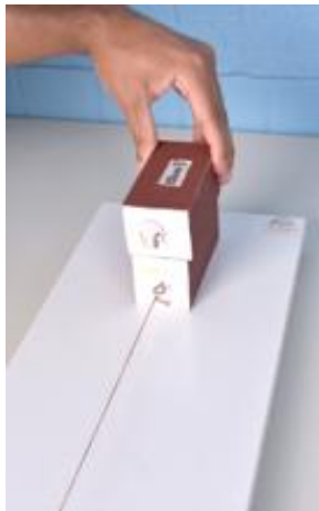
Figura 20 – Aumento da Força Normal
