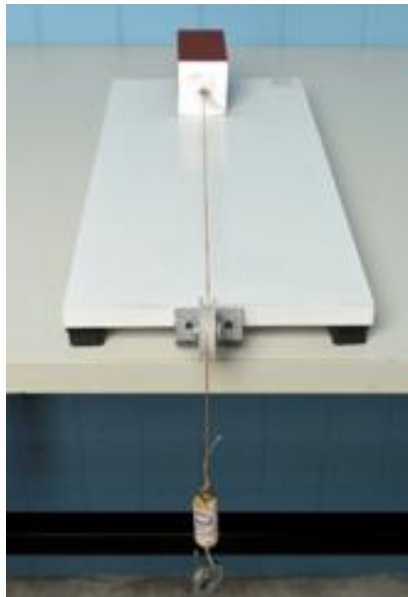
Figura 18 – Experimento 01: Atrito estático
