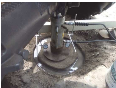
Fig. 6 – Canal de inundação em torno da placa.
