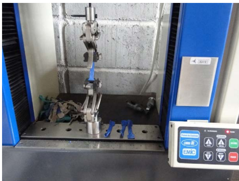
FIGURA 12.3. Dinamômetro da marca EMIC utilizado para realização da determinação da resistência do couro do beijupirá.
