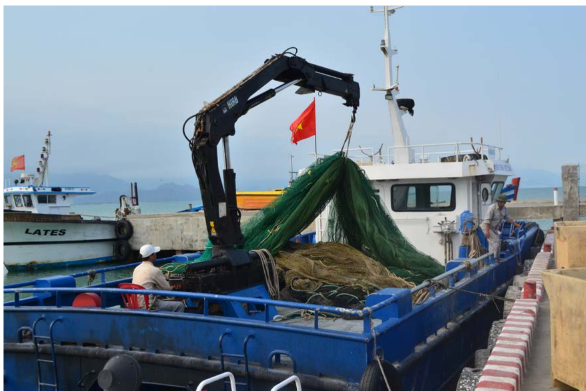
FIGURA 1.5. Barco da fazenda Marine Farms Vietnam equipado com guindaste para manuseio e transporte de equipamentos, materiais e insumos usados em gaiolas de grande volume para criação do beijupirá e pampo. Foto: Alberto Nunes.
