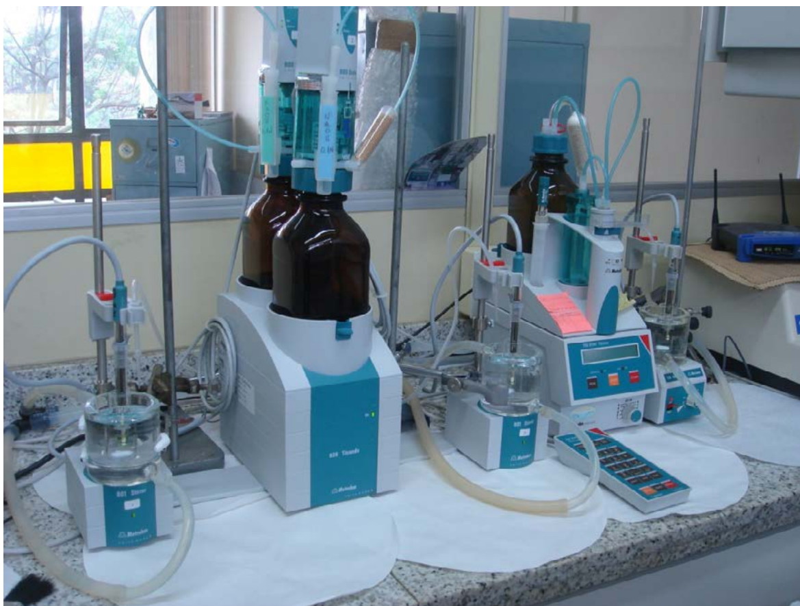
FIGURA 6.1. Sistema de análise composto de tituladores automáticos para a determinação do grau de hidrólise da proteína alimentar.
