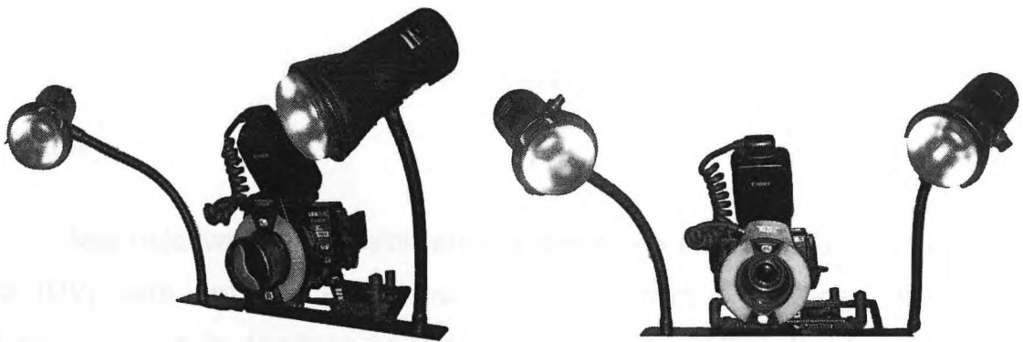
Figura 3 Suporte para câmera com duas fontes de luz articuláveis, desenvolvido pelo pesquisador: vistas lateral e frontal
