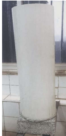
Figura 23-Estrutura utilizada para a realização do ensaio de colmatção
