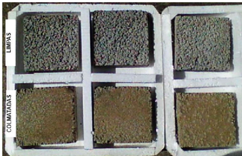
Figura 25 - Configuração do ensaio de temperatura de superfície das placas de concreto poroso limpas e colmatadas
