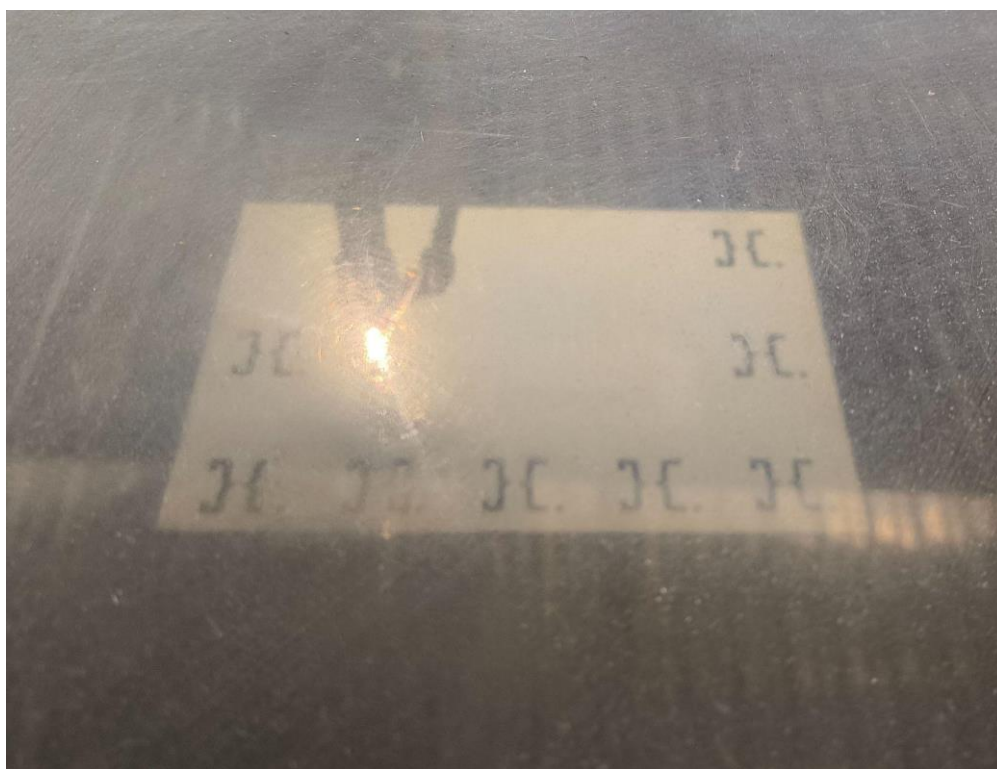
Figura 75 - Processo de Criação da padronagem de abertura de capítulo na máquina de corte à laser
