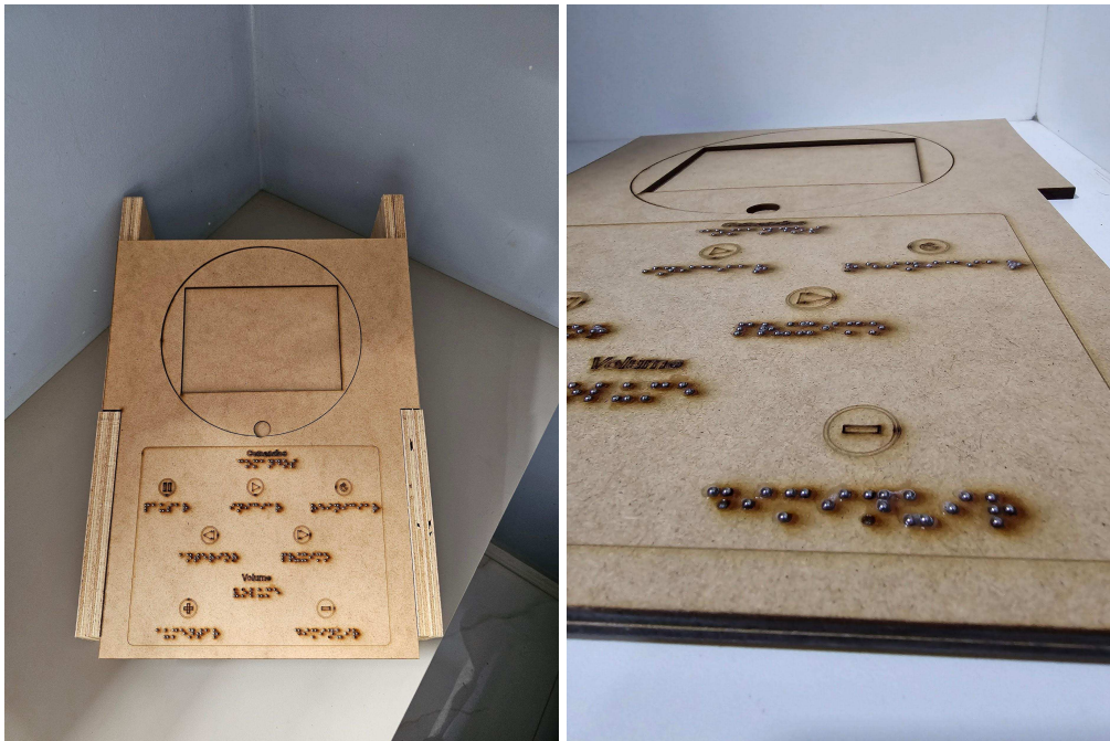
Figura 30 - Protótipo 3, em MDF com esferas de aço para simulação do Braille.
