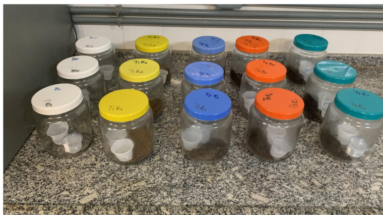
Figura 9 - Disposição dos frascos de vidro em repetições alinhadas por tratamentos. Branco: Teste em branco; Amarelo: Controle; Azul: Barreira; Laranja: Pomar; Verde: Horta.
