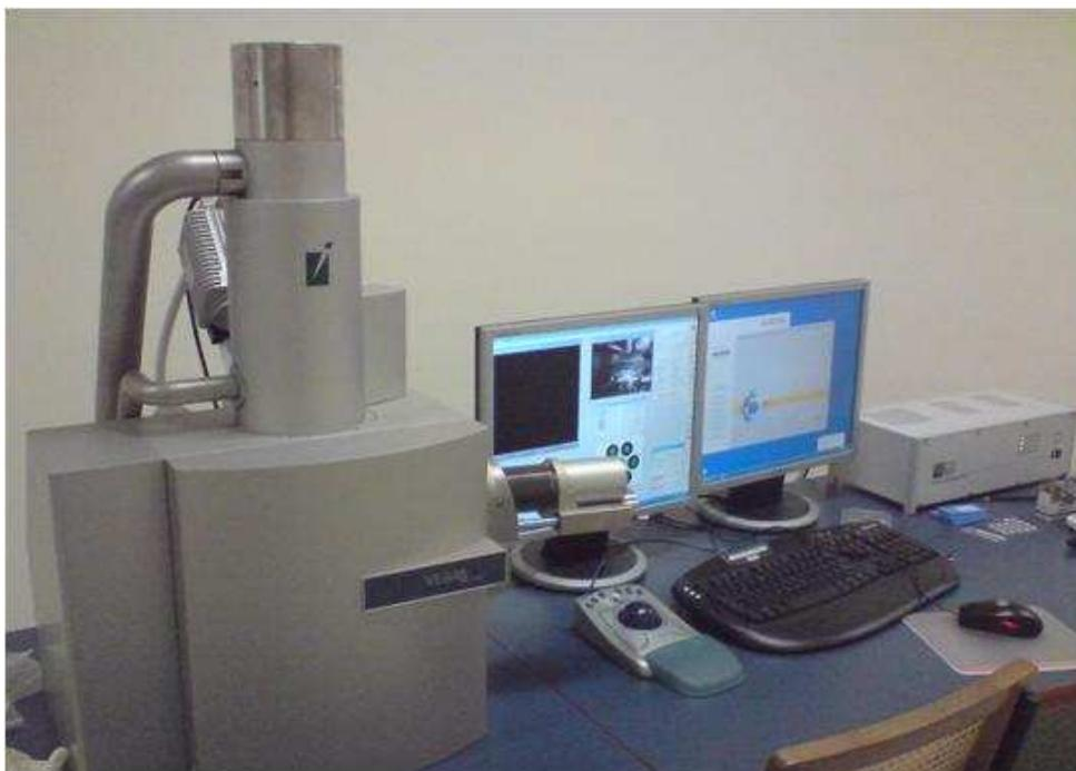
Figura 19: Microscópio Eletrônico de Varredura usado para o estudo da morfologia das amostras.
