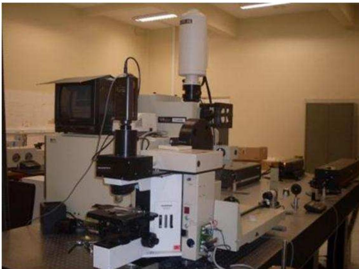
Figura 16: Espectrômetro T64000 da Jobin-Yvon acoplado ao sistema de micro-análise Raman.
