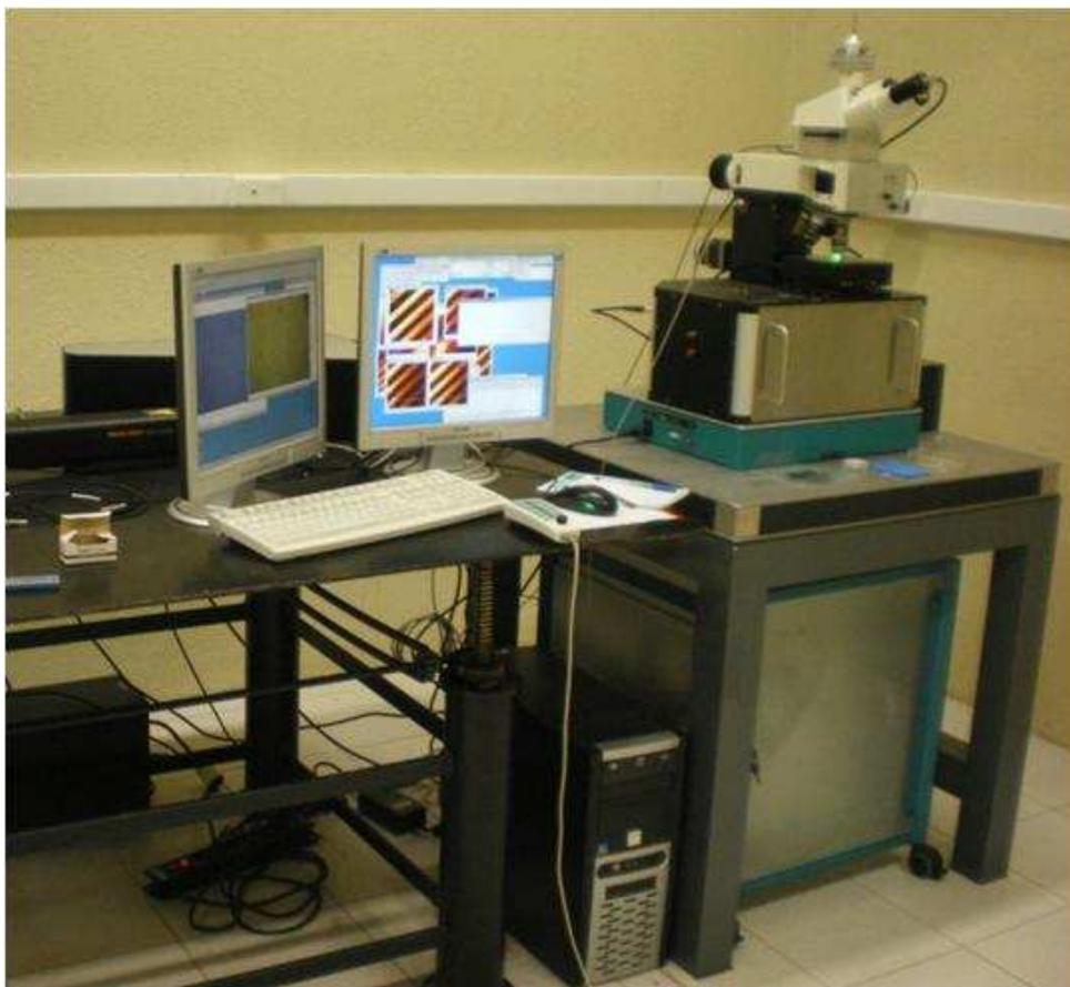
Figura 17: Sistema confocal Witec alpha300 usados nas medidas dos espectros Raman dos nanotubos de  $\text{MoO}_3$ .
