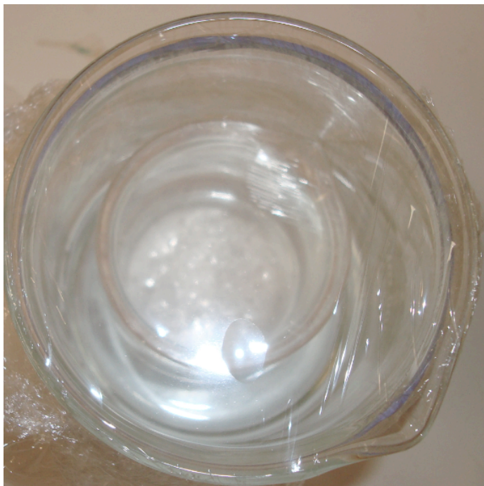
Figura 2.1: Difusão a vapor, método utilizado para obtenção dos cristais da DL-leucina.
