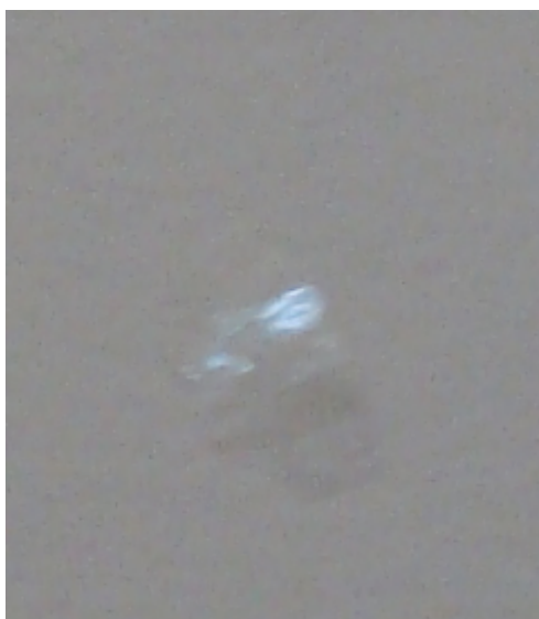
Figura 2.2: Cristal da DL-leucina, obtido pelo método de difusão a vapor.
