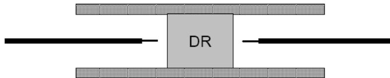
Figura 2.5 Configuração de um RD cilíndrico entre as placas condutoras paralelas e as sondas.
