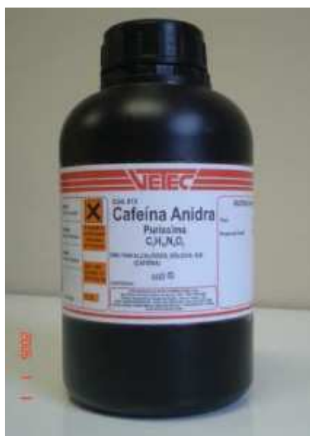
Figura 12: Pó comercial da cafeína anidra utilizada nos experimentos de espectroscopia Raman a altas temperaturas e altas pressões hidrostáticas.
