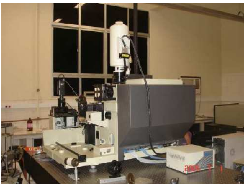
Figura 13: Espectrômetro triplo T64000 construído pela Jobin Ivon.
