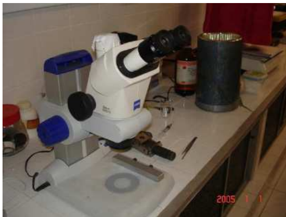
Figura 20: Microscópio utilizado na montagem da célula de pressão e ainda no alinhamento dos diamantes.
