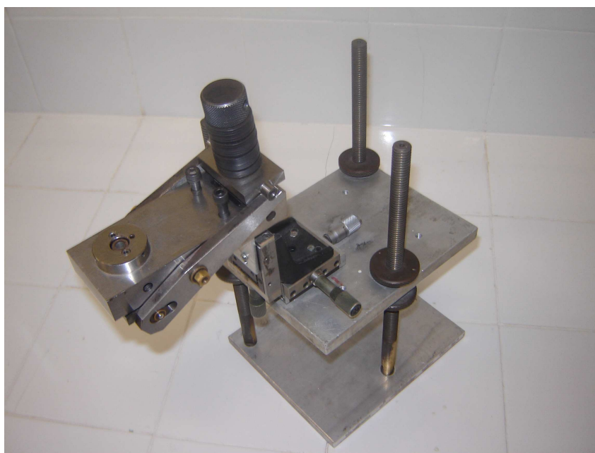
Figura 18: Célula de pressão (DAC - Diamond Anvil Cell ), utilizada nas medidas de espectroscopia Raman sob altas pressões.
