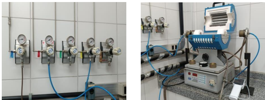
Figura 7 - Forno túnel EDG
