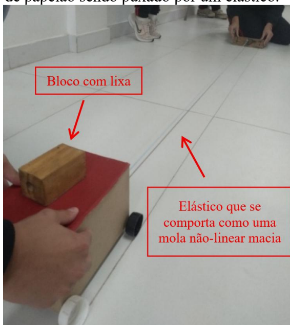
Figura 12 – Bloco com lixa sobre carrinho de papelão sendo puxado por um elástico.
