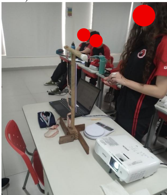
Figura 32 – Estudante colocando as arruelas na mola, após a medição das massas, e analisando a consequente deformação ocasionada por cada uma (3º ano do ensino médio).
