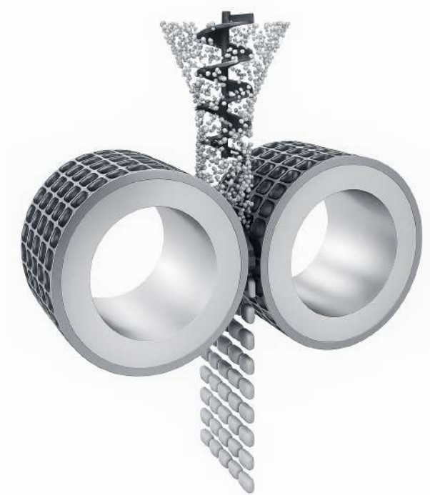
Figura 2 – Princípio da compressão em prensas de rolos - Modelo 3D.
