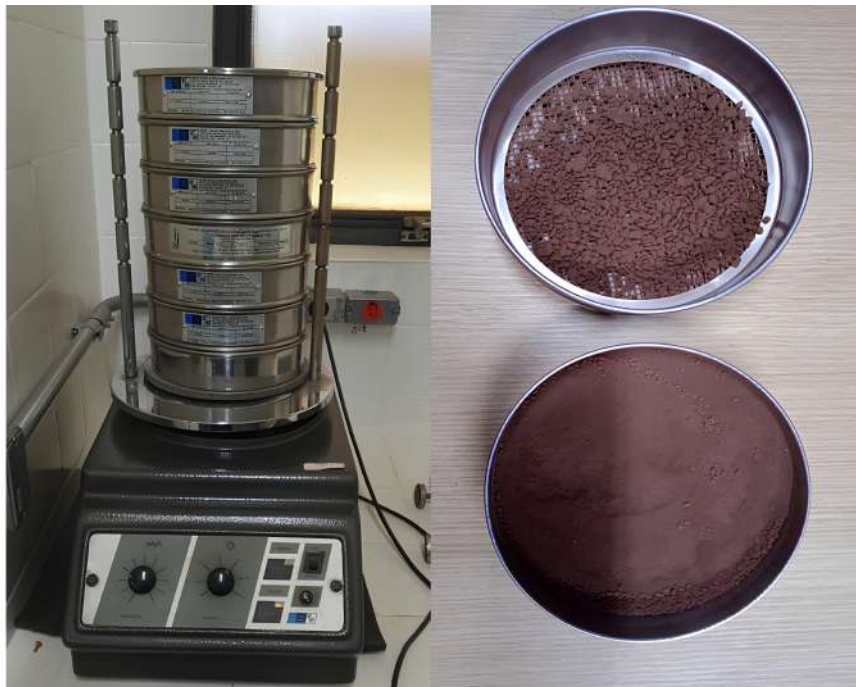
Figura 9 – Conjunto de peneiras de diversas aberturas fixadas a um agitador eletromagnético.
