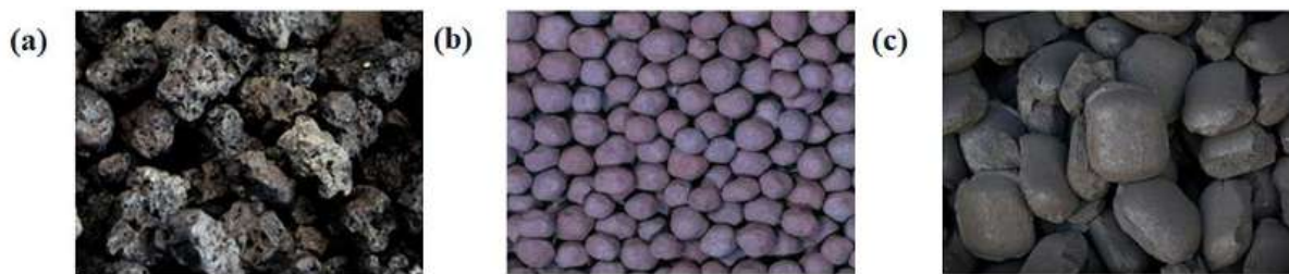
Figura 1 – Aglomerados de minério de ferro: (a) sinter, (b) pelotas e (c) briquetes.
